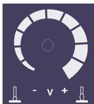
Ручка регулировки напряжения дуги
